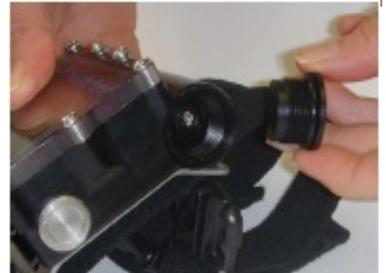
Tirez prudemment sur le logement de la pile. Pour éviter un rebond ou des vibrations de la pile, l'ensemble est très ajusté. Vous aurez donc besoin de quelque chose comme un outil de dentiste ou un trombone pour retirer le support.
