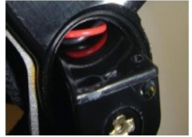
Inspectez, et si nécessaire, appliquez une légère couche de silicone sur le joint torique dans le bouchon du compartiment pile. Réinstallez le bouchon en prenant soin de ne pas coincer ou déformer le joint torique.
