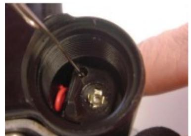
Les fils viennent du compartiment principal de l'ordinateur à travers un côté du compartiment de la batterie.
