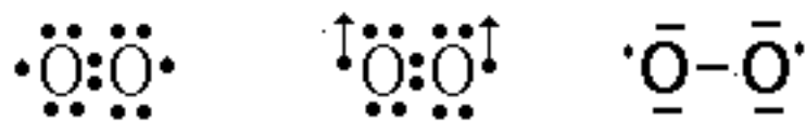
Fig. IV-2 : Représentations diverses des électrons de valence La représentation centrale insiste sur le caractère biradicalaire de l'oxygène en représentant les deux spins (vecteur orienté) des électrons "célibataires". On représente souvent, comme sur la figure de droite, les paires d'électrons par des barres - .
